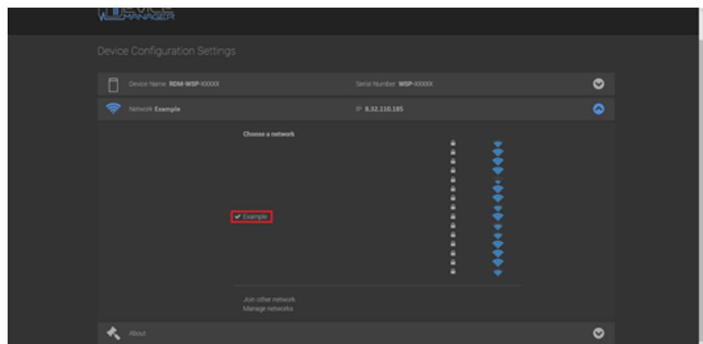
El dispositivo Micropod está ahora conectado a la red inalámbrica . Cierre la ficha Opciones de configuración de dispositivos y la utilidad de configuración Micropod.
