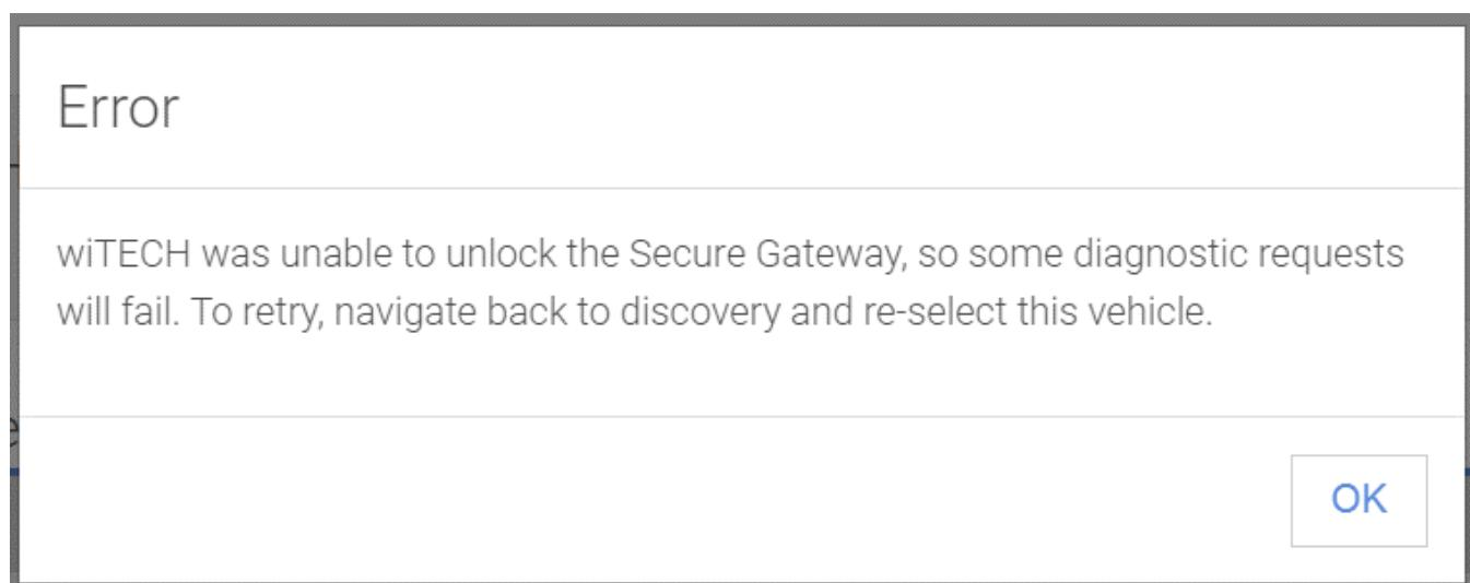
Si le module SGW ne parvient pas à se déverrouiller, l'utilisateur ne pourra afficher que les DTC et les affichages de données. L'utilisateur ne sera pas en mesure d'exécuter des fonctions telles que la programmation d'un ECU, la suppression des codes d'anomalie ou l'exécution de routines OBD.
